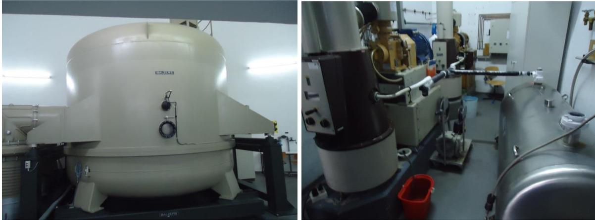
Equipo BALZERS de aluminizado y sala de producción de nitrógeno.
