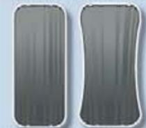
Neumático desgastado y neumático desgastado y con poca presión
