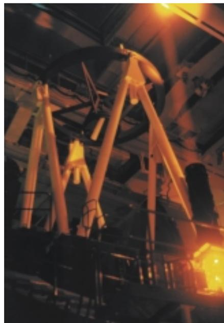
Abb. 4: Der Laserstrahl beim Austritt aus dem Projektionsteleskop (schwarzer Tubus rechts in der Bildmitte) sowie die darunter befindliche Analysebank. Am oberen Bildrand leuchtet der von der geschlossenen Kuppel reflektierte unfokussierte Laserstrahl.
