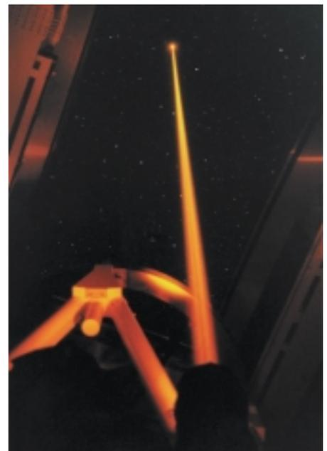
Abb. 5: Die Aufnahme zeigt den Laserstrahl beim Austritt aus der Teleskopkuppel. Gut erkennbar ist die Rayleigh-Rückstreuung sowie die Reflexion des Laserstrahls an einer Wolke. Abb. 4 und 5 wurden etwa 30 Sekunden lang belichtet.
