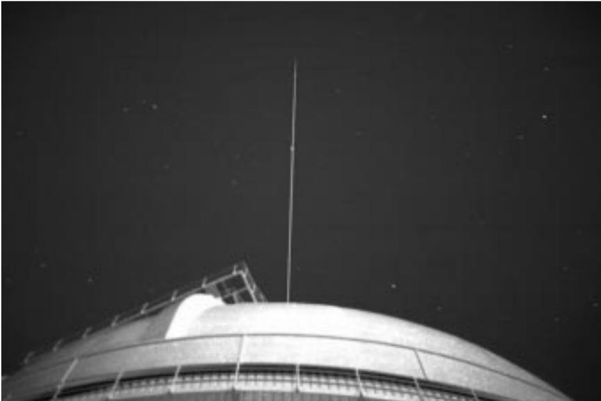
Abb. 10: Der Alfa-Laserstrahl über der Kuppel des 3.5-m-Teleskopes.
