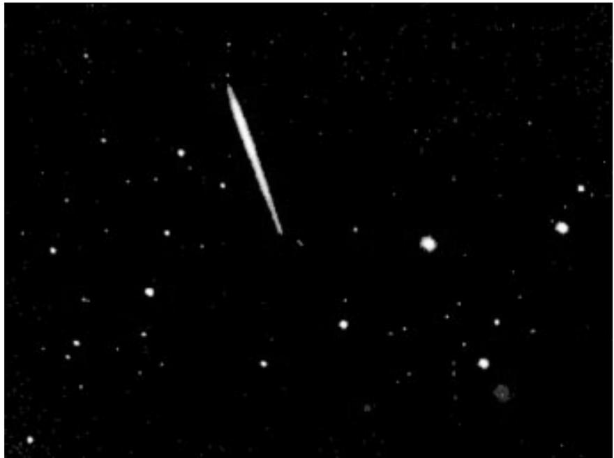
Abb. 12: Aufnahme des Natrium-Fleckens mit dem 1.23-m-Teleskop, 276 m vom 3.5-m-Teleskop entfernt. Aufgrund des Abstandes der beiden Teleskope und der Dicke der Natriumschicht (etwa 10 km, mit einer mittleren Höhe von 90 km) erscheint der Natrium-Fleck stark elongiert; seine Länge ist hier etwa 140". Die Helligkeitsverteilung längs des Striches gibt das Dichteprofil in der Natriumschicht wieder.
